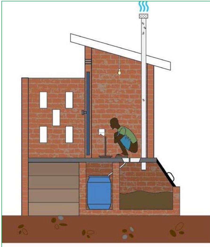
Figure 2-7: Urine Diversion Dry Toilet (UDDT)
